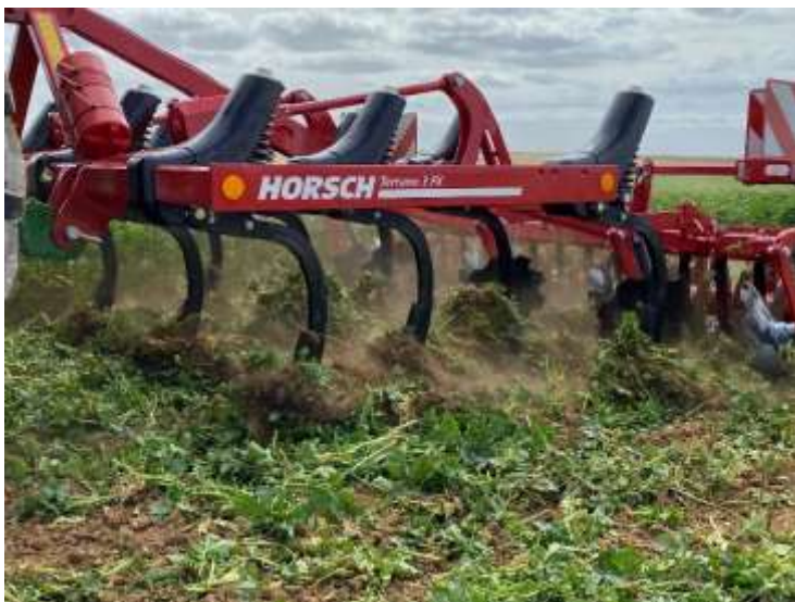
Le Horsh Terrano au travail avec les ailerons TerraCut
