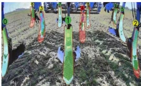
sous forme de feux de signalisation, la perte de socs étant signalée en rouge, les socs endommagés ou usés en jaune et les socs intacts en vert.
