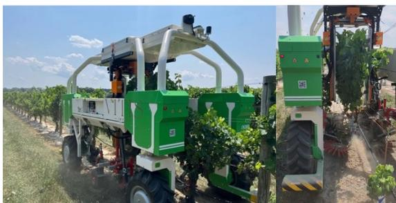
Vitisimport teste le travail combiné avec la rogneuse et les interceps mécaniques
