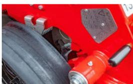
Capteur AutoForce sur un élément semeur
