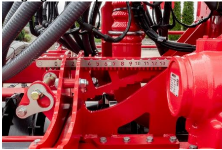
Réglage de la profondeur de travail de la herse rotative
