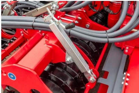
Réglage de la hauteur de la lame de nivellement
