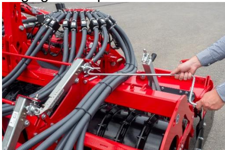
Réglage de la profondeur de semis et de la pression appliquée sur les éléments semeurs
